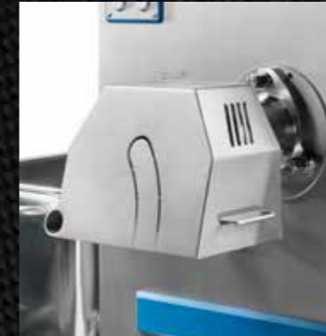
Gehäuseauslaufschutzhaube Outlet protection cover
